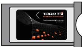
САМ-модуль (Conditional Access Module Smit Conax) – устройство, предназначенное для обеспечения доступа при помощи смарт-карты к закодированным телевизионным каналам и просмотра их на вашем телевизоре.
