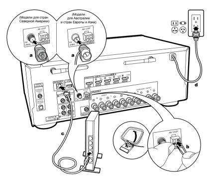
а Комнатная FM-антенна, **b** Комнатная AM-антенна, **c** Ethernet-кабель, **d** Кабель питания
