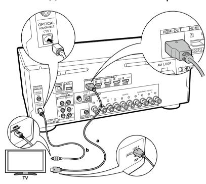
а Кабель HDMI. **b** Цифровой оптический кабель
