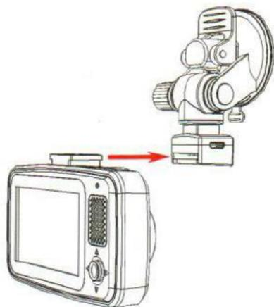
Установите регистратор в салазки кронштейна. Кронштейн и регистратор имеют магниты с помощью которых происходит фиксация. Прижмите присоску к чистому, сухому и теплему стеклу. Переведите рычаг вакуумной присоски вверх. Для регулировки положения по вертикали, открутите пластиковый барашек. Для регулировки положения по горизонтали просто поверните регистратор. Для снятия регистратора с кронштейна, потяните его на себя.
