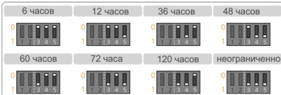
Если таймер настроен, устройство подает питание на видеорегистратор на указанное заранее время, а затем отключает электропитание. Кроме того, функция таймера работает только тогда, когда двигатель останавливается автоматически отключается, если двигатель запускается.
