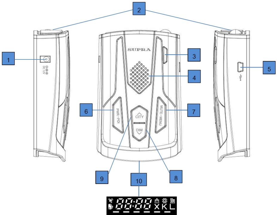
1. DC 12V Разъем для подключения адаптера питания (входное напряжение 12 В)
