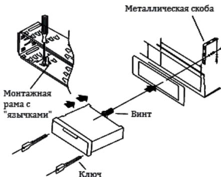
1. Вставьте до упора ключи, входящие в комплект поставки, в пазы на боковых поверхностях передней панели. Извлеките прибор из монтажной рамы.
