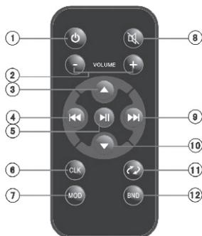
1. Кнопка включения/выключения аппарата
