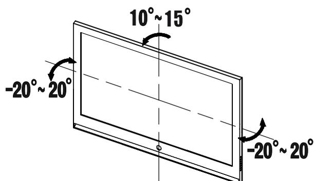
Не применяйте силу при регулировке угла.
