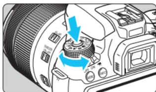
Поверните диск, удерживая нажатой центральную кнопку разблокировки диска.
