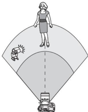
Здесь описывается полностью автоматическая съемка с одной внешней беспроводной вспышкой Speedlite и встроенной вспышкой.
