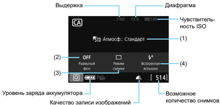
Если установить в камере параметр (1) или (2) при съемке в режиме Live View, то перед съемкой можно посмотреть эффект на экране.
