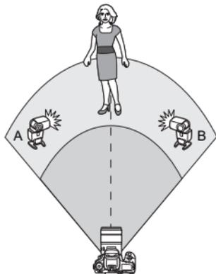
Можно разделить ведомые устройства на группы А и В и изменять соотношение мощности вспышек для создания необходимых эффектов освещения. Руководствуясь инструкцией по эксплуатации вспышки Speedlite, выберите для одного ведомого устройства группу вспышек А, а для другого — группу вспышек В. Расположите вспышки Speedlite, как показано на рисунке.
