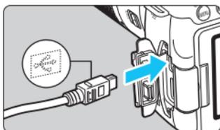
**2** Подключите камеру к компьютеру с помощью интерфейсного кабеля (продается отдельно).
