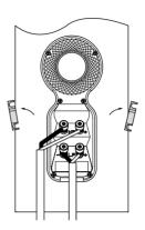
Подсоедините плюсовой разъем колонки (со знаком + и окрашенный в красный) к плюсовому выходу усилителя, а минусовой (со знаком – и окрашенный в черный) – к минусовому на усилителе. Неверное подключение приведет к искажению звукового образа и утере басов.
