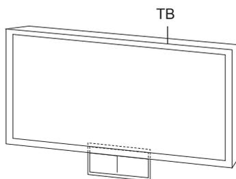
2. При креплении на стену (из бетона), используйте дюбели. Вам потребуется просверлить несколько отверстий. Чтобы просверлить отверстия используйте листок (шаблон для установки настенных кронштейнов), входящий в комплект поставки. Используйте этот листок, чтобы наметить точки для сверления отверстий.
