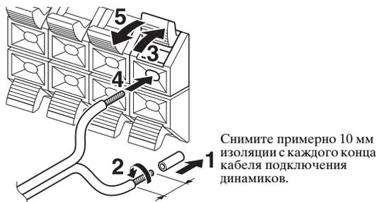
Снимите примерно 10 мм изоляции с каждого конца кабеля подключения динамиков.
