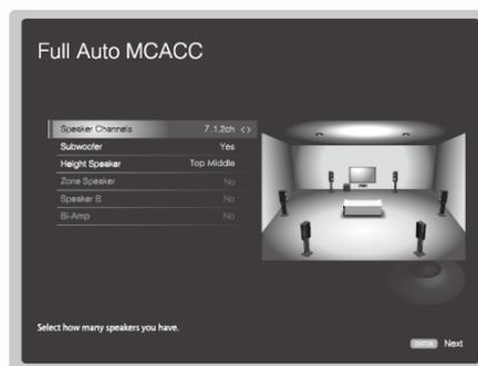
Изображение на экране зависит от числа каналов, указанного в "Speaker Channels", и его следует использовать в процессе настройки. При использовании верхней АС выберите 5.1.2ch и т. п. Используйте этот экран для указания наличия подключенного сабвуфера, выбора типа верхней АС и т. п.
