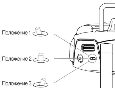
Режим P («позиционирование»): Режим P лучше всего использовать при наличии устойчивого сигнала GPS. В режиме P предусмотрены три варианта полета, которые Phantom 3 автоматически выбирает в зависимости от мощности сигнала GPS и данных датчиков визуального позиционирования:
