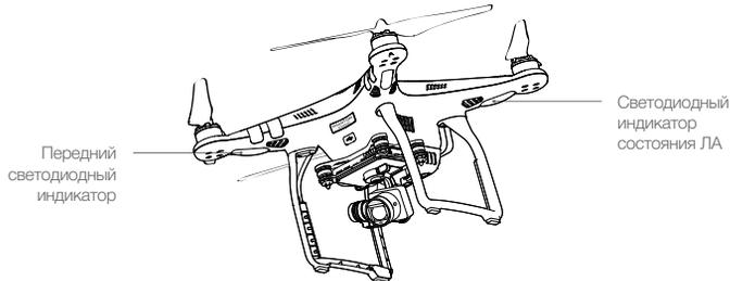
Передние светодиодные индикаторы показывают ориентацию ЛА. Передние светодиодный индикаторы постоянно горят красным, когда ЛА включен, и обозначают переднюю (носовую) часть ЛА. Светодиодные индикаторы состояния ЛА показывают системное состояние системы автоматического управления ЛА. В таблице ниже указана информация о сигналах светодиодных индикаторов состояния ЛА:
