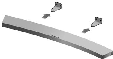
5. Вставьте **Крепление держателя** в каждое отверстие на нижней панели устройства. Зафиксируйте каждое **Крепление держателя** для закрепления системы Soundbar к 2 деталям **Кронштейн-стена**.
