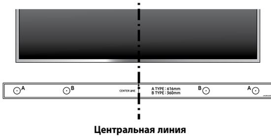
2. Совместите **Center Line (Центральную линию)** ориентира для монтажа на стене с центром ТВ (если устанавливаете систему Soundbar под ТВ), и закрепите **Wall Mount Guide (Ориентир для монтажа на стене)** липкой лентой.
