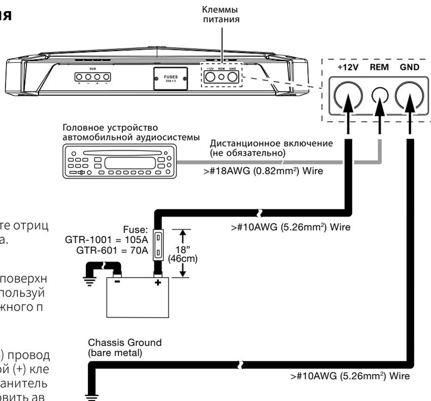
**ВНИМАНИЕ:** Перед началом установки отсоедините отрицательную (-) клемму автомобильного аккумулятора.
