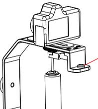
4. Затяните стандартный винт крепления камеры для надежности.
