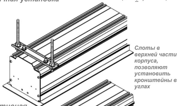
**Альтернативная установка (требуется дополнительная установка кронштейнов)**
