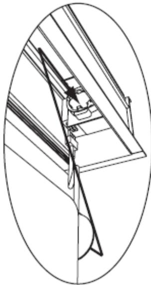
**РЕГУЛИРОВКА БЕЛОГО КОНТАКТНОГО ГНЕЗДА** – белое гнездо расположено на приводном конце вала экрана и может регулироваться маленькой отверткой. Вращение гнезда против часовой стрелки даст возможность валу развернуться дальше вверх или вниз (в соответствии со схемой). Вращение гнезда по часовой стрелке сократит операцию,resultируя более быстрой остановкой. Один полный оборот гнезда изменяет позицию остановки просмотровой поверхности приблизительно на 32 мм.
