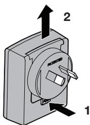
2. Поднимите адаптер вверх и снимите.
