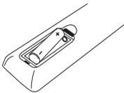
Снимите крышку отсека для батарей на задней части пульта дистанционного управления и вставьте одну батарею (размера AAA), соблюдая полярность  $\oplus$  и  $\ominus$ .
