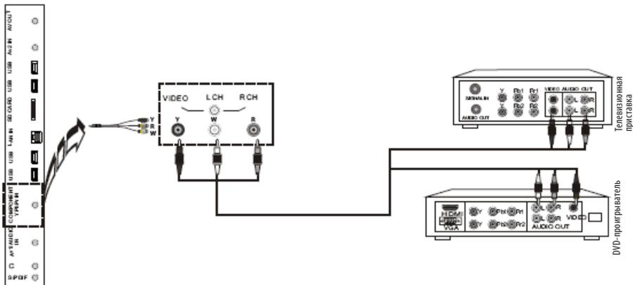
Подключите разъемы на одном конце аудио/видеокабеля к видеовходу телевизора VIDEO и парному аудиовходу L CH – R CH, разъемы на другом конце кабеля подключите к телевизионной приставке или DVD-проигрывателю. Цвета штекеров кабеля должны соответствовать цветам разъемов, к которым они подключаются.
