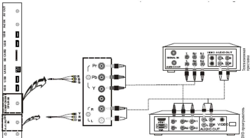
С помощью компонентного кабеля соедините разъемы компонентного видеовхода телевизора Y-Pb-Pr разъемы компонентного видеовхода подключаемого оборудования. Цвета штекеров кабеля должны соответствовать цветам разъемов, к которым они подключаются.
