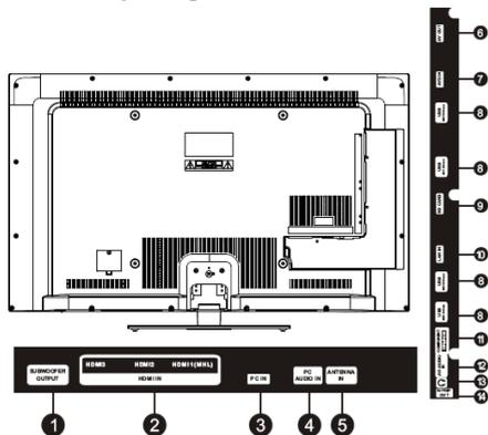
1. SUBWOOFER OUTPUT – Аудиовыход для подключения акустической системы низких частот (сабвуфера) - расчетная мощность до 30 Вт, сопротивление 6 или 80м
