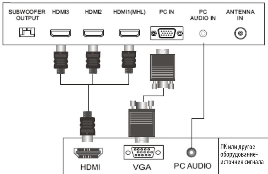
Для подсоединения устройств по интерфейсу HDMI подключите один конец HDMI кабеля к разъему HDMI DVD-проигрывателя или другого аудио/видеоустройства к разъему HDMI телевизора.
