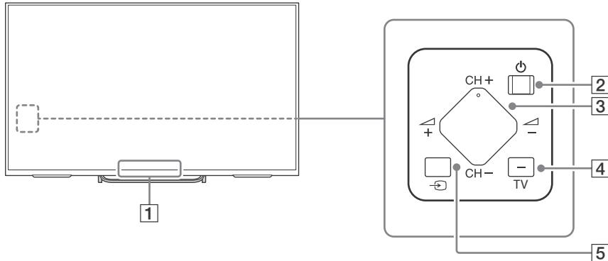
**[1] Датчик пульта дистанционного управления\*<sup>1</sup> / светочувствительный датчик\*<sup>1</sup> / светодиодный индикатор / передатчик Sync 3D-сигнала\*<sup>1,2</sup>**
