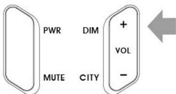
Последовательно нажимайте кнопку **DIM (+)**, чтобы установить нужную яркость подсветки дисплея в зависимости от условий освещения. Вы можете выбрать следующие режимы яркости подсветки: слабая, темная или яркая.
