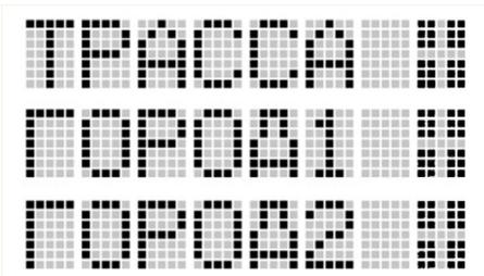
Последний, восьмой символ дисплея служит для индикации включения диапазонов приёма радар-детектора и голосового сопровождения (см. раздел «Меню системных настроек»).
