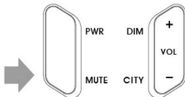
Нажмите кнопку **MUTE**, чтобы отключить звуковой сигнал об обнаружении сигнала радара. Еще раз нажмите кнопку **MUTE**, чтобы включить звук снова.
