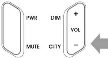
В современных городах, и в промышленных зонах ваш детектор может столкнуться с множеством слабых радиосигналов, не относящихся к сильным сигналам полицейского радара (сигналы микроволновых антенных мачт, устройств автоматического открывания дверей и т.п.). Чтобы детектор не реагировал на ненужные сигналы, в нем предусмотрен режим пониженной чувствительности Город (City), который значительно сокращает количество ложных срабатываний.
