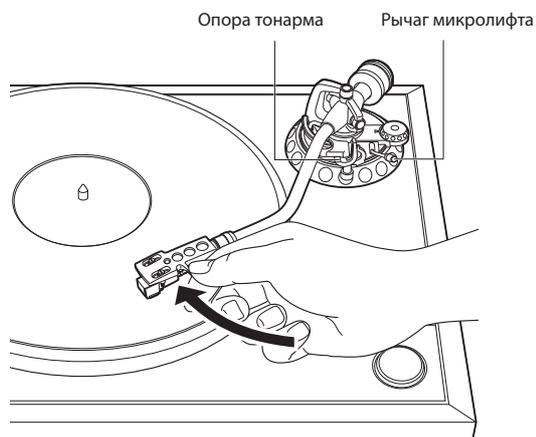
5. Поворачивайте противовес для подстройки тонарма таким образом, чтобы он возвращался в почти горизонтальное положение (\*), когда рука его отпускает. В процессе подстройки следите, чтобы игла не касалась резинового коврика или диска.
