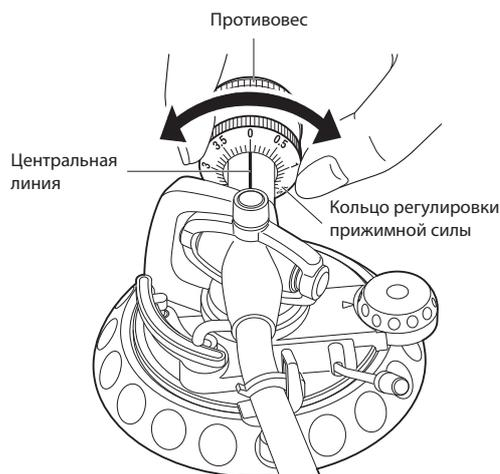
2. Поверните противовес в направлении стрелки так, чтобы белая центральная линия на оси позади тонарма находилась на «3,5».
