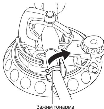
4. Освободите тонарма с опоры. Оставьте рычаг микролифта в опущенном состоянии.
