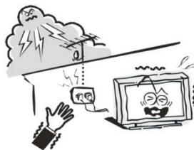
Для дополнительной защиты данного телевизора при грозовой погоде или когда не планируется его использование в течение длительного времени, отключите телевизор от розетки питания и отсоедините антенную кабель. Это предотвратит повреждение телевизора от молнии или из-за перепадов напряжения.
