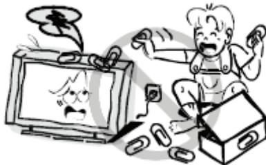
Никогда не вставляйте посторонние предметы в вентиляционные отверстия и открытые части телевизора. При эксплуатации телевизора используется высокое напряжение. Попадание посторонних предметов внутрь телевизора может послужить причиной поражения электрическим током и привести к повреждению деталей телевизора. Детям младше 3 лет не следует пользоваться телевизором.
