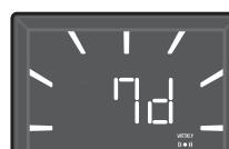
Выбор режима Weekly Alarm завершает настройку будильника. Загораются индикаторы сигнала будильника () и Weekly Alarm (WEEKLY).
