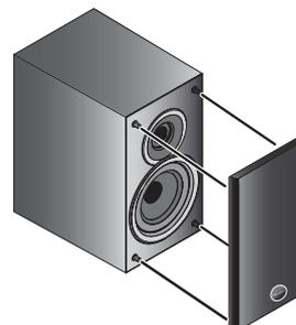
**3 Поверните винты на обратной стороне решетки по часовой стрелке с помощью крестообразной отвертки.**
