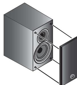
1 Возьмитесь за низ решетки и осторожно потяните его на себя, чтобы снять нижнюю часть.
