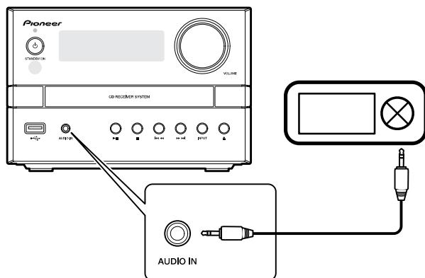
**1 Подключите стереофонический кабель с мини-штекером (продается отдельно) к гнезду AUDIO IN на передней панели основного блока и гнездам наушников на внешнем устройстве (например, MP3 проигрыватель).****2 Нажмите AUDIO IN на пульте ДУ или повторно нажмая INPUT на основном блоке, переключите источник на [AUDIO IN].****3 Запустите воспроизведение на внешнем устройстве.**
