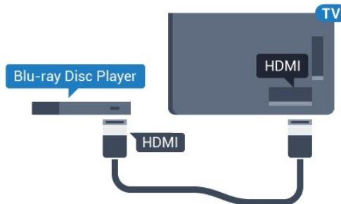
Если проигрыватель Blu-ray поддерживает технологию EasyLink HDMI CEC, им можно управлять при помощи пульта ДУ телевизора.
