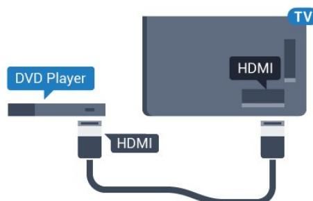
Если DVD-проигрыватель подключен через HDMI и поддерживает технологию EasyLink CEC, им можно управлять при помощи пульта ДУ телевизора.
