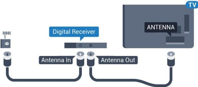
После подключения антенны добавьте кабель HDMI, чтобы подключить приставку к телевизору. Кроме того, если на телеприставке нет HDMI-разъема, можно использовать кабель SCART.
