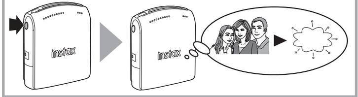
Нажмите и удерживайте кнопку ПОВТОРНАЯ ПЕЧАТЬ более 5 секунд при включенном принтере. Светодиод состояния мигает 1 секунду и изображение удаляется.
