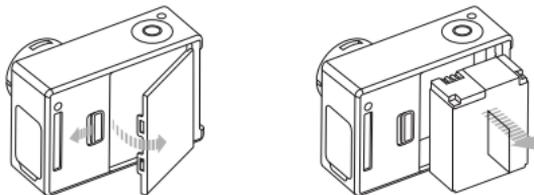
1. Снимите крышку отсека для аккумулятора, вставив палец в углубление аккумуляторного отсека (на задней панели камеры) и отодвинув его влево.
