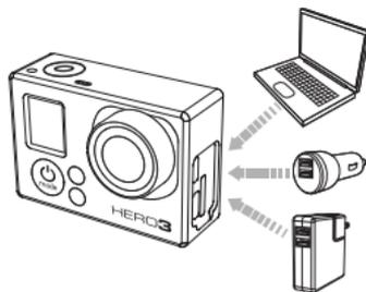
При зарядке при помощи USB-совместимых зарядных устройств GoPro мощностью 1000mAh (GoPro Wall Charger или GoPro Auto Charger) уровень заряда аккумулятора достигает 80% в течение часа и 100% в течение двух часов. При использовании других зарядных устройств аккумулятор может заряжаться дольше.
