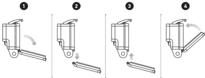
1. Откройте заднюю крышку таким образом, чтобы она опустилась вниз.
