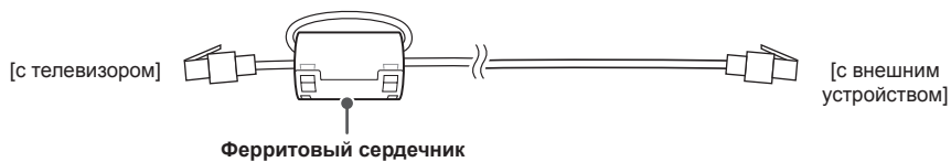
[Вид ферритового сердечника в разрезе]
