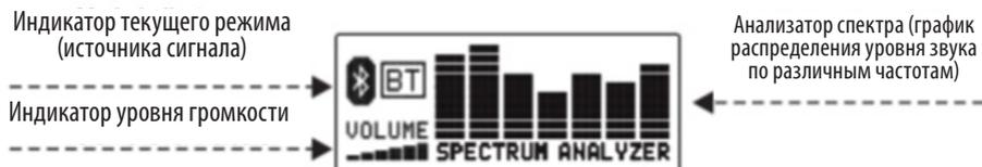
При выборе некоторых режимов (источников сигнала) можно изменять режимы дисплея. Для этого нажимайте кнопку DISPLAY MODE.
