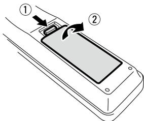
② Вставьте две батарейки, соблюдая полярность, указанную маркировкой в отсеке для батареек.
