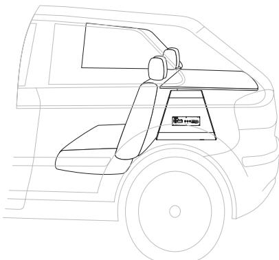
**Примечание.** При определения места для установки убедитесь, что сабвуфер надежно закреплен и не может перемещаться внутри багажника, и не касается других объектов. Повреждение сабвуфера посторонними предметами не покрывается гарантией.
