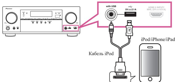
**Подключение устройства USB**
