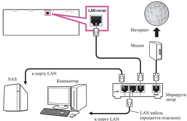
Подключите терминал LAN на данном ресивере к терминалу LAN на маршрутизаторе (с или без встроенной функции DHCP сервера) через прямой LAN кабель (CAT 5 или выше).
