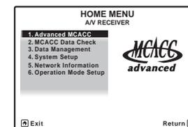
На телевизоре отображается экран графического интерфейса пользователя (ГИП). Для перехода между экранами и выделенными пунктами меню используйте **↑/↓/←/→** и **ENTER**. Нажмите **RETURN** для выхода из текущего меню.
