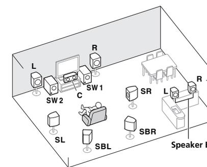
Данные подключения позволяют одновременно прослушивать 5,2-канальное объемное звучание в основной зоне и стереофоническое воспроизведение того же источника от громкоговорителей В. Те-же самые подключения также позволяют воспроизводить 7,2- канальное объемное звучание в основной зоне, когда громкоговорители В не используются.
