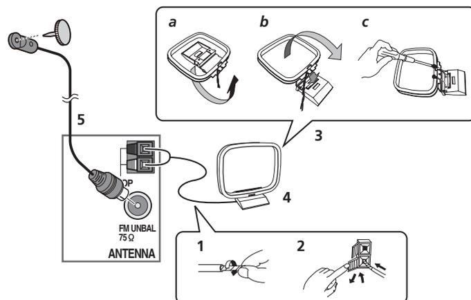
**1** Снимите предохранительные щитки с контактов антенны AM.
