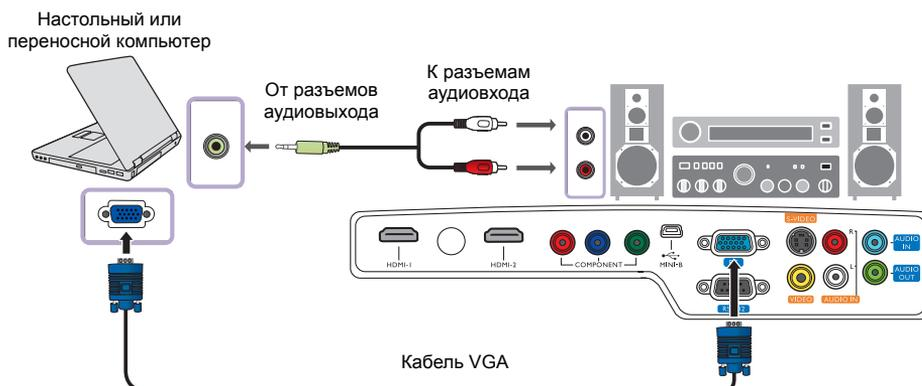
Внешние видеопорты многих переносных компьютеров не активируются автоматически при подключении к проектору. Для активации вывода сигнала на внешний дисплей обычно требуется нажать специальную комбинацию клавиш (например FN+F3 или CRT/LCD). Найдите на портативном компьютере функциональную клавишу CRT/LCD или клавишу с символом монитора. Нажмите одновременно кнопку FN и эту функциональную клавишу. Сведения о комбинациях клавиш приводятся в документации портативного компьютера.
