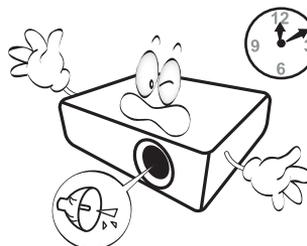
11. Во время работы лампа проектора сильно нагревается. Перед извлечением блока лампы выждите примерно 45 минут, пока проектор остынет.
