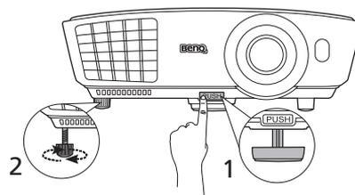
1. Нажимая кнопку регулятора наклона, поднимайте переднюю часть проектора. Добившись надлежащего положения изображения, отпустите кнопку быстро выдвигающейся ножки, чтобы зафиксировать ножку в соответствующем положении.
