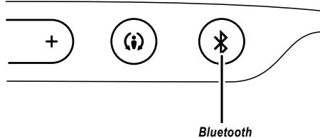
2. Переведите устройство в режим связывания. С помощью меню связывания через Bluetooth устройства свяжите его со звуковой панелью. (В меню устройства звуковая панель будет видна как «SB200».) Если устройство запросит код, введите «0000».
