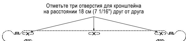
3. Используя инструменты и фурнитуру, подходящие для материала и конструкции стены, прикрепите кронштейн к стене в отмеченном месте, проследив, чтобы он прилегал к ней своей плоской стороной. Помните, что вес звуковой панели составляет 3,4 кг (7,5 фунта). Используйте фурнитуру, которая может выдержать этот вес.
