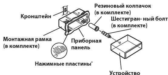
\* Если установленный монтажный рамка не закреплен в приборной панели, то эту проблему можно устранить за счет небольшого расширения нажимных пластин.
