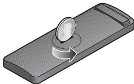
2. Снимите крышку и вставьте новый элемент питания (CR2032 или DL2032) плоской стороной вверх, чтобы был виден знак (+).
