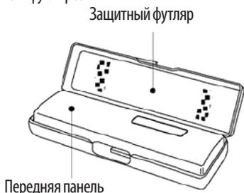
Чтобы установить переднюю панель, сначала закрепите ее правую часть. Затем прижмите левую часть передней панели к ресиверу до щелчка.
