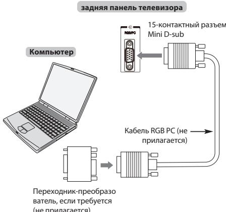
Для использования ПК задайте на нем выходное разрешение для монитора до подключения компьютера к телевизору. Для получения информации о форматах сигналов ПК см. стр. 77.
