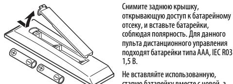
Снимите заднюю крышку, открываяющую доступ к батарейному отсеку, и вставьте батарейки, соблюдая полярность. Для данного пульта дистанционного управления подходят батарейки типа AAA, IEC R03 1,5 В.
