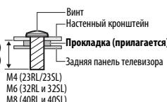
**ВНИМАНИЕ:** Диаметр и длина винтов отличаются в зависимости от модели стенного кронштейна. Использование каких-либо других винтов, отличающихся от указанных винтов, может привести к неисправности внутренних устройств телевизора или к его падению и т.п.
