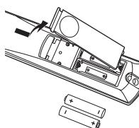
Снимите заднюю крышку, открывющую доступ к батарейному отсеку, и вставьте батарейки, соблюдая полярность. Для данного пульта дистанционного управления подходят батарейки типа АА, IEC R6 1,5 В.
