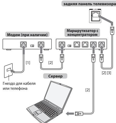
[1] Коаксиальный или телефонный кабель (в зависимости от типа модема)
