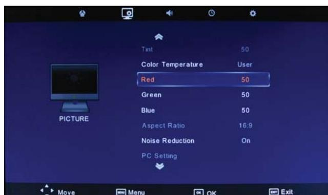
**Picture Mode** - Режим изображения. Выбрав один из режимов изображения: Standard (Стандартный), Dynamic (Динамический), Mild (Мягкий), вы можете одновременно отрегулировать яркость, контрастность, насыщенность и резкость изображения. Если вы установите режим User (Пользовательский), то сможете самостоятельно настроить параметры изображения самостоятельно. Вы также можете выбрать режим изображения, нажимая кнопку PICTURE.
