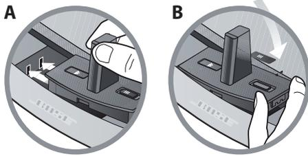
5. Нажмите правую часть док-станции до щелчка для надежной фиксации (B).
