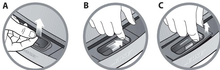
3. Нажмите кнопку док-станции (B) справа и поднимите правую сторону (C) док-станции для ее извлечения.
