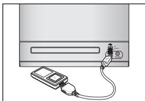
1. Подключите внешнее устройство хранения USB к порту USB на основном устройстве.
