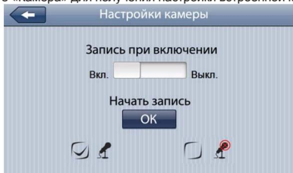
Для автоматического старта записи после включения навигатора нажмите Вкл для «Запись при включении»
