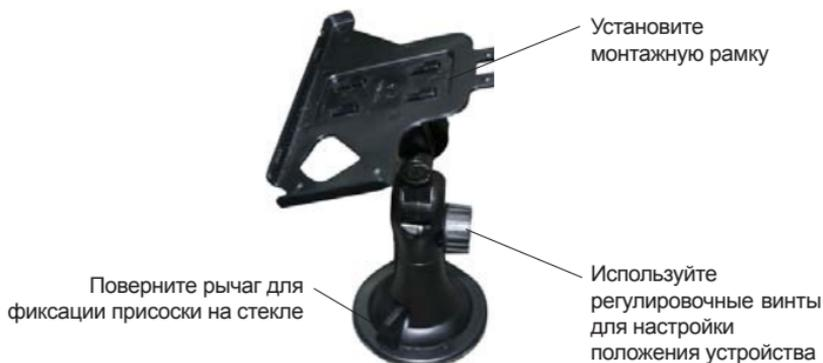
1. Снимите защитную пленку с присоски. Далее, поместите держатель в удобном для Вас месте на лобовом (или боковом) стекле. Следите, чтобы в месте контакта присоски стекло было чистое. Поверните рычаг фиксатора по часовой стрелке до упора. При выборе места установки не перекрывайте обзор водителю. Если стекло покрыто металлизированной отражающей пленкой, то может понадобиться подключение внешней приемной антенны GPS, поскольку прием на внутреннюю антенну будет затруднен из-за отраженного сигнала.
