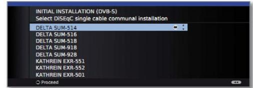
Выбрать однокабельную систему общего пользования DiSEqC
