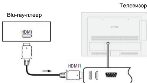
Пример подключения HDMI-устройства (например, Blu-ray-плеера)
