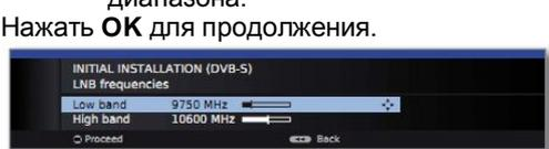
Установить частоты конвертора LNB
