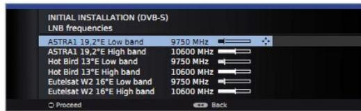
Установить частоты конвертора LNB.
