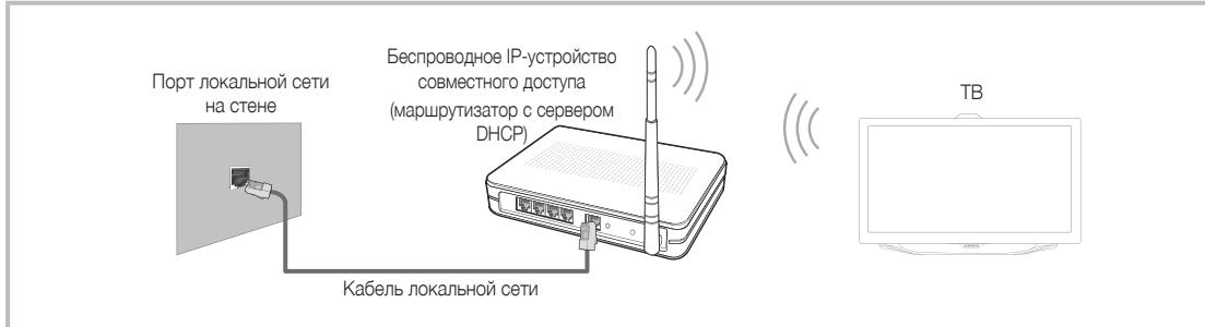
Адаптер беспроводной локальной сети Samsung поддерживает протоколы связи IEEE 802.11A/B/G и N. Samsung рекомендует использовать протокол IEEE 802.11N. При воспроизведении видео через соединение IEEE 802.11B/G возможны перерывы.
