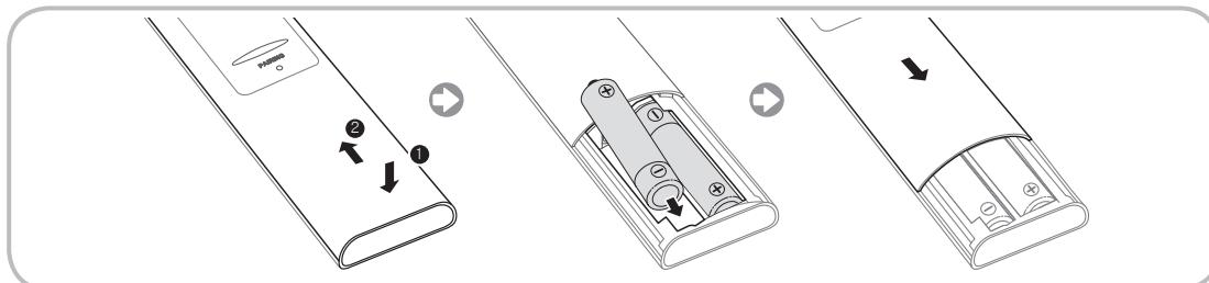
1. Двумя большими пальцами нажмите на нижнюю часть задней стенки пульта дистанционного управления и потяните крышку батарейного отсека в направлении, указанном стрелкой.
