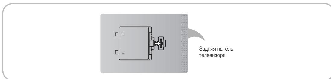
Данный разъем предназначен для подключения устройства расширения, которое называется Evolution Kit. Он позволяет запускать в системе телевизора самые разные новейшие приложения, расширяющие возможности пользователя.
