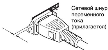
Между вилок и задней панелью остается небольшой зазор, даже когда сетевой шнур надежно вставлен. Сетевой шнур должен подключаться именно таким образом. Это не является неисправностью.
