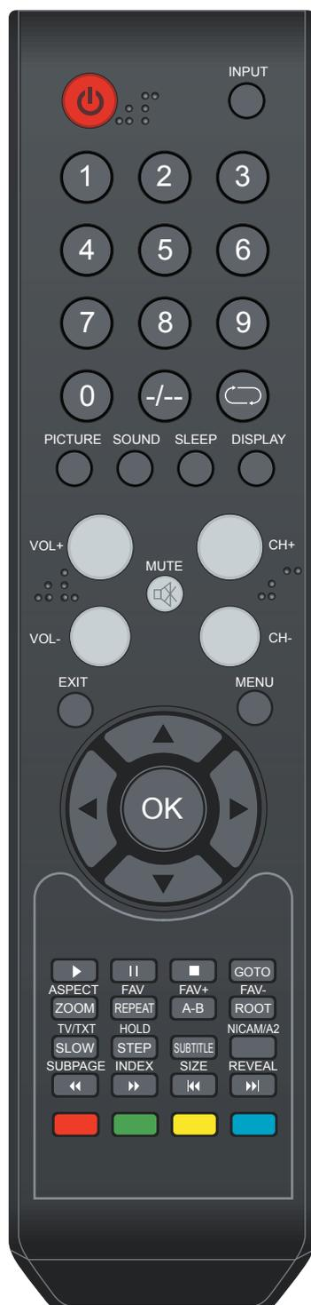
**⏻** : Кнопка включения/выключения телевизора.
