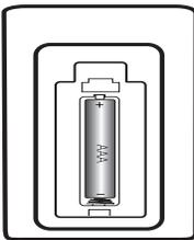
Снимите крышку батарейного отсека на задней панели пульта ДУ и установите одну батарейку (типоразмера AAA) с соблюдением полярности (+ и -).
